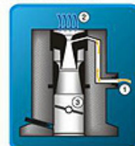
Des.2. Carburator (1) – carburant; (2) – aer; (3) – clapeta carburatorului; (4) – depuneri
